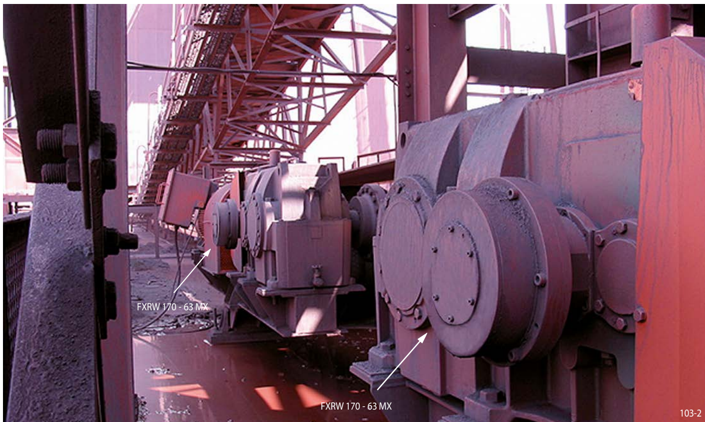
Planta transportadora de minério de ferro na África do Sul movida por três redutores de engrenagens com Contra-recuos RINGSPANN FXRW 170-63 MX.
